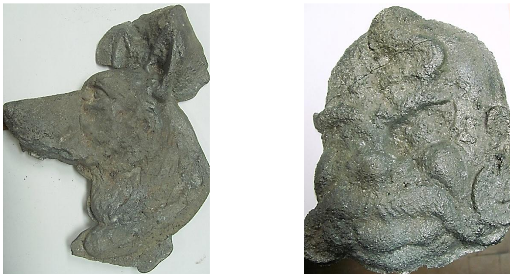
Рис. 6. Виливки, отримані у формах із сумішей з фосфатами натрію
